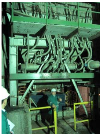
Figura 8. Cunicolo di trasferimento del carrello. Occorre segnalare che questa soluzione di raccolta rende agevole la raccolta e la movimentazione, riducendo la probabilità di dispersioni ed emissioni diffuse che possono derivare da queste operazioni.
